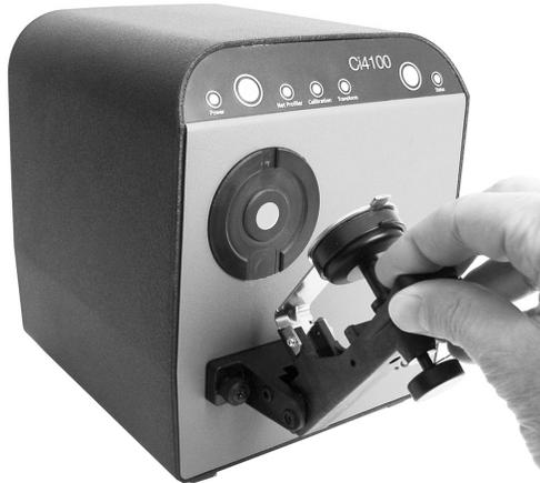
3. Tirare indietro la manopola e inserire il campione di colore tra il morsetto e il fermo. Assicurarsi di che il lato del campione da misurare sia di fronte all'apertura dello strumento.
