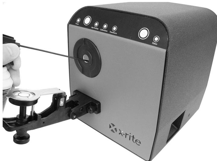
**IMPORTANTE:** se una bomboletta di aria compressa è utilizzata per la pulizia, non invertire o inclinare la bomboletta durante l'uso. Ciò potrebbe provocare danni all'ottica dello strumento.
