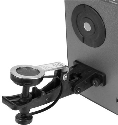
7. Eseguire la procedura di calibrazione del nero (con la porta aperta) dall'applicazione software. L'indicatore di stato cambia dal colore ambra allo stato spento e l'indicatore della calibrazione diventa verde. Questa è un'indicazione che la procedura di calibrazione è riuscita.
