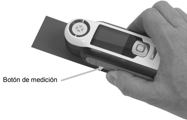
Las orientaciones horizontal, vertical y angulada se aceptan siempre que el instrumento constituya un buen contacto con la muestra.
