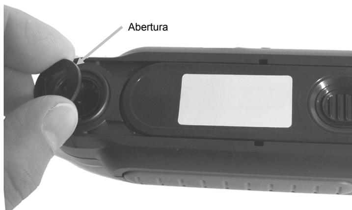
3. Sople cuidadosamente ráfagas cortas de aire limpio y seco en el puerto de la óptica. Esto eliminará los residuos acumulados en el área de la óptica.
