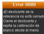
**Nota:** aparece un mensaje de error si la tapa deslizante de la referencia blanca no se encuentra en la posición correcta para la calibración. Si esto ocurre, cierre la tapa y repita el procedimiento de calibración. Si este mensaje sigue apareciendo después de volver a calibrar, consulte la sección Solución de Problemas en los Apéndices.
