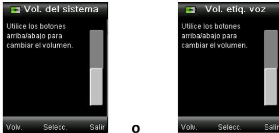
5. Ajuste otro nivel de volumen o bien presione el lado derecho del control de **Navegación** (Salir) para ir a la pantalla Igualar.
