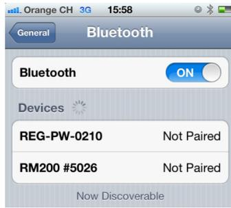
5. Wählen Sie das CAPSURE RM200 #XXXX, um das Messgerät mit dem iOS-Gerät zu koppeln.
