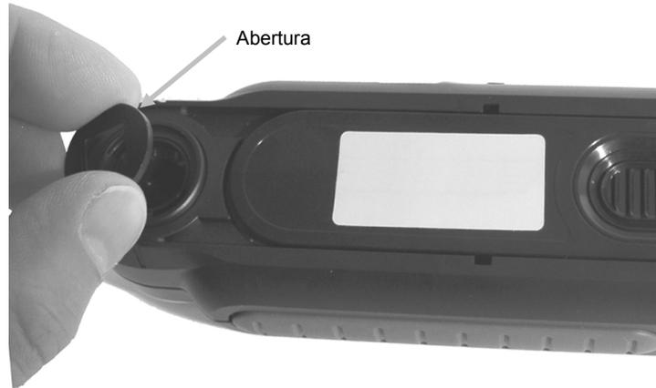
3. Sopre jatos curtos de ar seco e limpo para dentro do conjunto óptico. Isso deverá remover os detritos acumulados sobre os componentes ópticos do instrumento.
