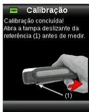
**Nota:** aparecerá uma mensagem de erro se a tampa deslizante da referência branca não estiver na posição correta para a calibração. Caso isto ocorra, feche a tampa deslizante e repita o processo de calibração. Após a recalibração, se tal mensagem continuar aparecendo, consulte a seção Solução de Problemas nos Apêndices.
