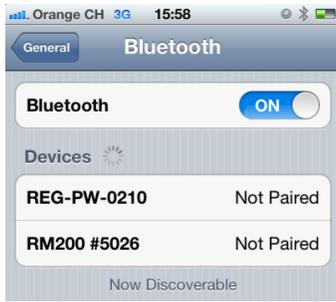
5. Sélectionnez CAPSURE RM200 #XXXX pour appairer l'instrument à l'appareil iOS.
