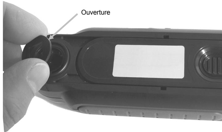
3. Soufflez de courtes bouffées d'air propre dans le port de l'optique afin d'éliminer toutes les poussières.
