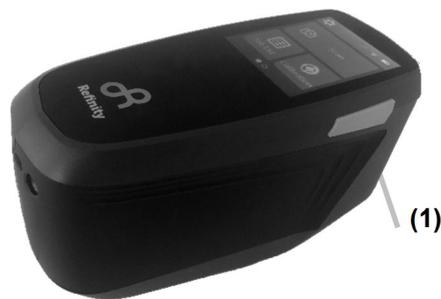
All'accensione, il dispositivo viene sottoposto a un test diagnostico. Il LED di stato e lo schermo si illuminano di bianco, seguiti da una schermata di avvio prima della schermata principale. Questa sequenza di avvio viene completata in pochi secondi.
