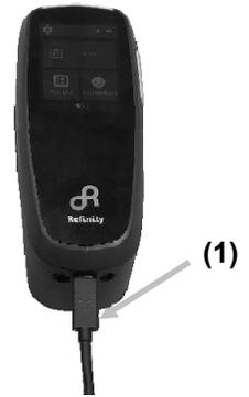
4. Aprire il coperchio della base d'appoggio. Inserire il dispositivo nella base d'appoggio con il connettore USB-C rivolto verso il basso. Usa i due perni (2) come guida. Il cinturino da polso si inserisce nella scanalatura nella parte inferiore della base d'appoggio.
