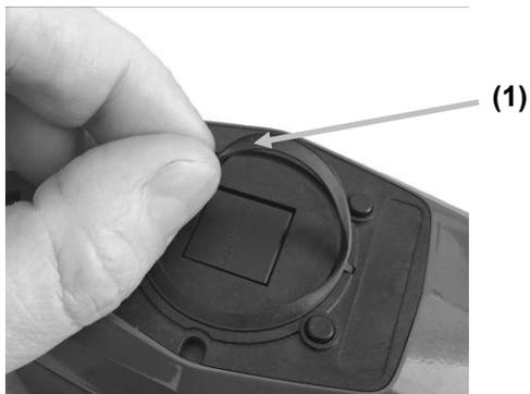
2. Posizionare la nuova guarnizione a tenuta di luce sopra la zona incassata intorno all'apertura di misurazione.
