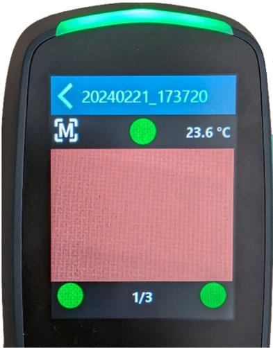
Esempio 1: Tutti i sensori contattano correttamente ed è possibile prendere una misurazione
