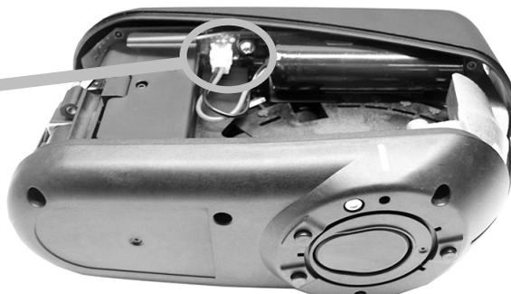
4. Insira o novo conjunto de baterias na presilha e encaixe o conector das baterias.
