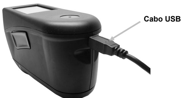
Durante o carregamento, o instrumento liga-se e um ícone na forma de "relâmpago" indica que a recarga está em execução. O instrumento não se desligará enquanto estiver conectado a uma porta USB do computador, contudo, entrará no modo de espera. Isto é indicado por um LED azul pulsante.
