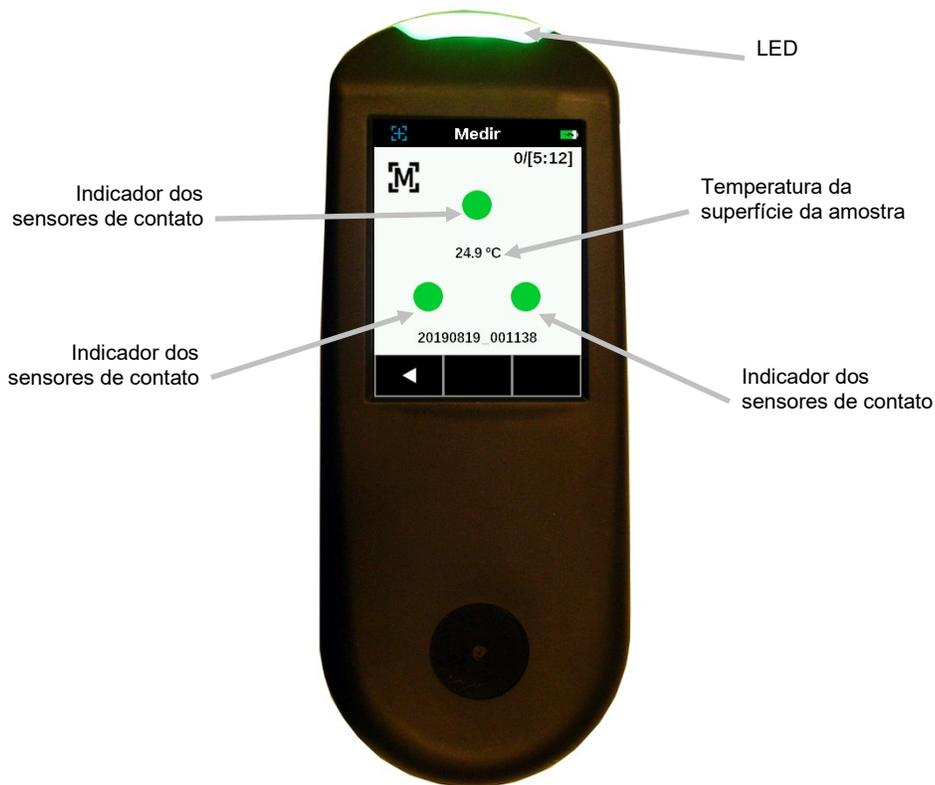
Os LED multicores localizados na frente do instrumento fornecem informações visuais sobre o estado de uma medição e dos sensores de contato.
