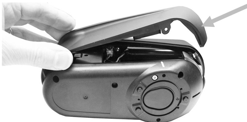
3. Pressione a presilha para baixo na parte superior do conector das baterias. Lentamente desencaixe o conector das baterias e retire o conjunto de baterias antigo.
