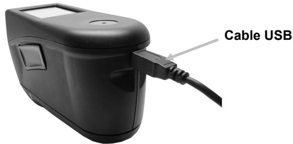
Durante la carga, el instrumento se enciende e indica el proceso mediante un icono de batería en la forma de "rayo". El instrumento no se apagará mientras esté conectado al puerto USB de la computadora, pero pasará al modo de espera. Esto se indica mediante un LED azul parpadeante.
