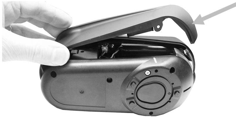
3. Presione la presilla hacia abajo en la parte superior del conector de las baterías. Desenchufe el conector de las baterías y retire el paquete de baterías viejas.
