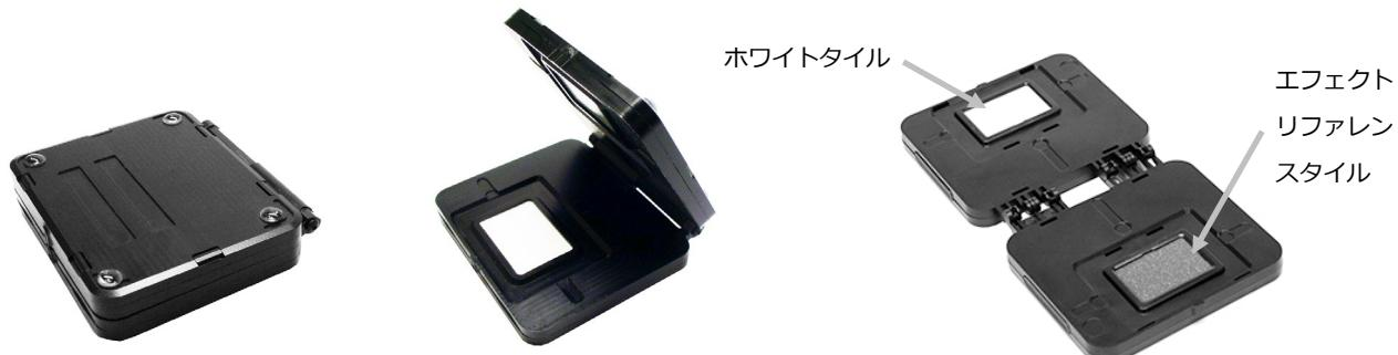
装置の測定ポート（1）を、キャリブレーション基準板の白色タイル（2）上にセットしてください。測定ポートの3つの圧力センサーがキャリブレーション基準板の3つの穴（3）と一致し、白線（4）が基準板のマークと一致していることを確認してください。
