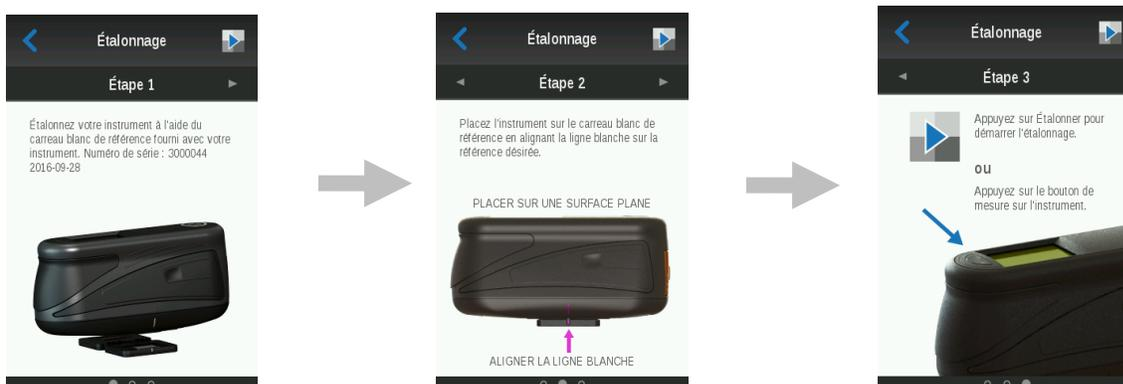
4. Lorsque vous êtes prêt, appuyez sur le bouton **Mesurer** situé sur la partie supérieure de l'instrument ou appuyez sur l'icône Étalonner
