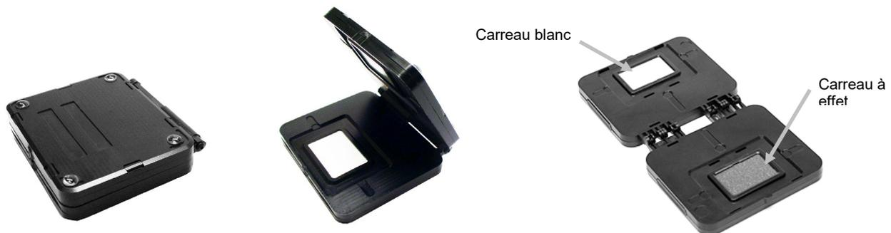
Positionnez le port de mesure de l'instrument (1) sur le carreau blanc (2) de la référence d'étalonnage. Veillez a) à aligner les trois capteurs de pression situés autour du port de mesure avec les fentes (3) de la référence d'étalonnage, et b) à aligner la ligne blanche (4) avec les marques de référence.
