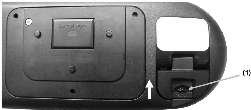
2. Insérez le nouveau bloc-batterie (2) dans l'instrument en orientant les contacts vers le bas jusqu'à ce que le bloc-batterie soit positionné sous le loquet de retenue (3).
