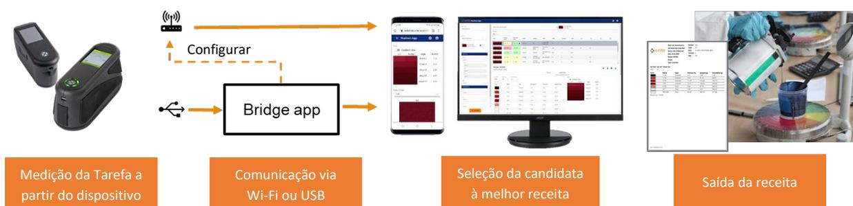
O aplicativo Auto SC Web é compatível com as medições de trabalhos enviadas por Wi-Fi a partir dos dispositivos MA-3, MA-5 e MA-T5. Também é possível enviar os trabalhos por meio de conexão USB para um computador utilizando o aplicativo Bridge para os mesmos dispositivos e para o instrumento MA91.
