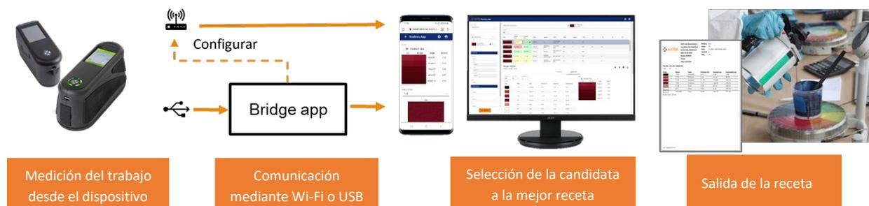
La aplicación Auto SC web es compatible con mediciones de trabajos enviadas por medio de Wi-Fi desde los dispositivos MA-3, MA-5 y MA-T5. También es posible enviar los trabajos mediante una conexión USB a una PC usando la aplicación Bridge para los mismos dispositivos y el instrumento MA91.
