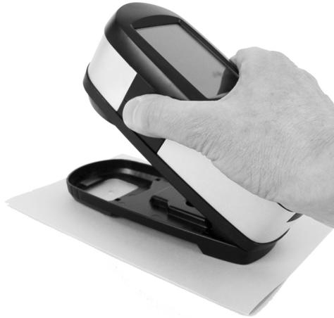
3. Mantenga el instrumento firmemente hasta que aparezca el mensaje "FINALIZADA" y los datos de la medición en la pantalla. Esta es una indicación de que la medición se ha realizado correctamente.
