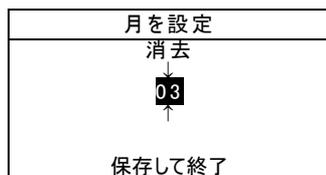
2. 選択キー ↑ ↓ を使い、入力する数値の位に矢印を移動します。(上下の矢印は選択中の位を表します。)エンターキー ↵ を押して英数字エディターにアクセスします。
