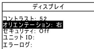
2. 選択キー ↑↓ を使い、右か左か希望する方向を選択します。エンターキー ← を押して設定を保存し、ディスプレイメニューに戻ります。
