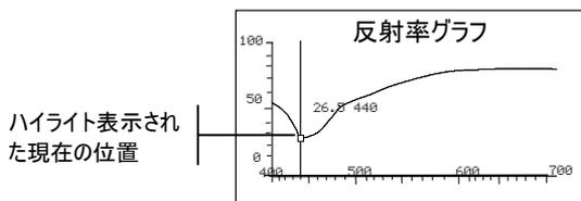
3. 選択キー  $\uparrow/\downarrow$  を繰り返し押して、分光反射率の曲線と共に測定データを 10nm ごとに表示します。
