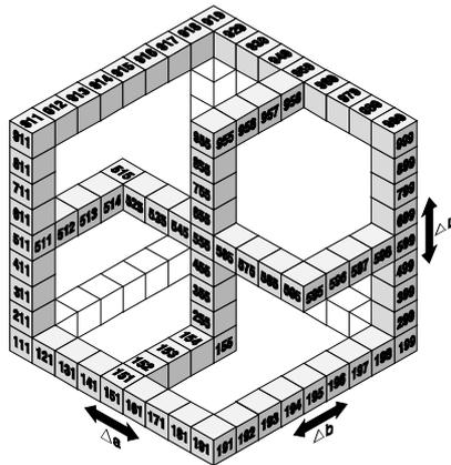
シェード分類範囲は、使用・表示されるシェードボックスの範囲 (各軸のボックスの数) を設定します。範囲は三次元空間で 1 から 9 まで設定できます。
