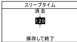
3. 選択キー ↑↓ を使い、希望するスリープタイムの時間を選択します。(上下の矢印が選択されている位を表します。) エンターキー ← を押して英数字エディターにアクセスします。
