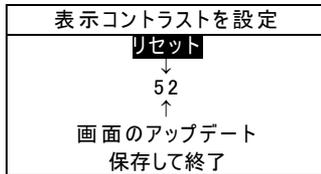
3. 選択キー↑↓を使い、希望するコントラスト (数値) を選びます。(上下の矢印が選択している位を表します。)エンターキー ← を押して英数字エディターにアクセスします。
