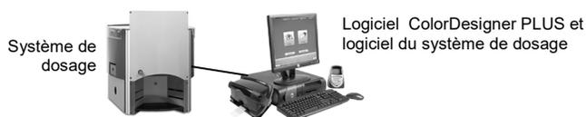
**Direct** - ColorDesigner PLUS communique directement avec le système de dosage. Le pilote du système de dosage est généralement fourni par le fabricant du système de dosage. Aucune configuration utilisateur n'est requise pour la connexion.
