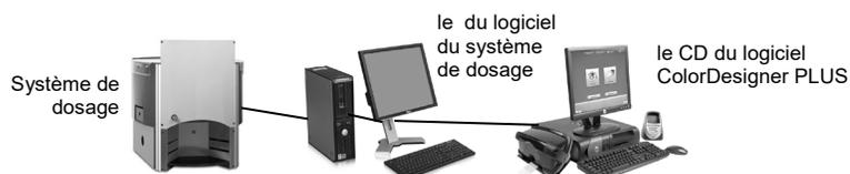
**Intégré** - ColorDesigner PLUS communique avec le logiciel du système de dosage sur le même ordinateur. Cette communication s'effectue généralement par le biais d'un fichier de formule qui est écrit sur le disque de l'ordinateur.
