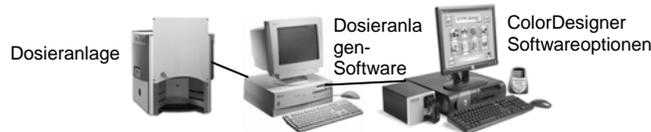
**Integriert** - In dieser Konfiguration ist die Software für die Dosieranlage auf dem gleichen Computer wie ColorDesigner installiert, und kann so direkt mit der Dosieranlage kommunizieren. Die Kommunikation findet durch eine Rezeptierdatei, die auf dem Computer gespeichert ist, statt.
