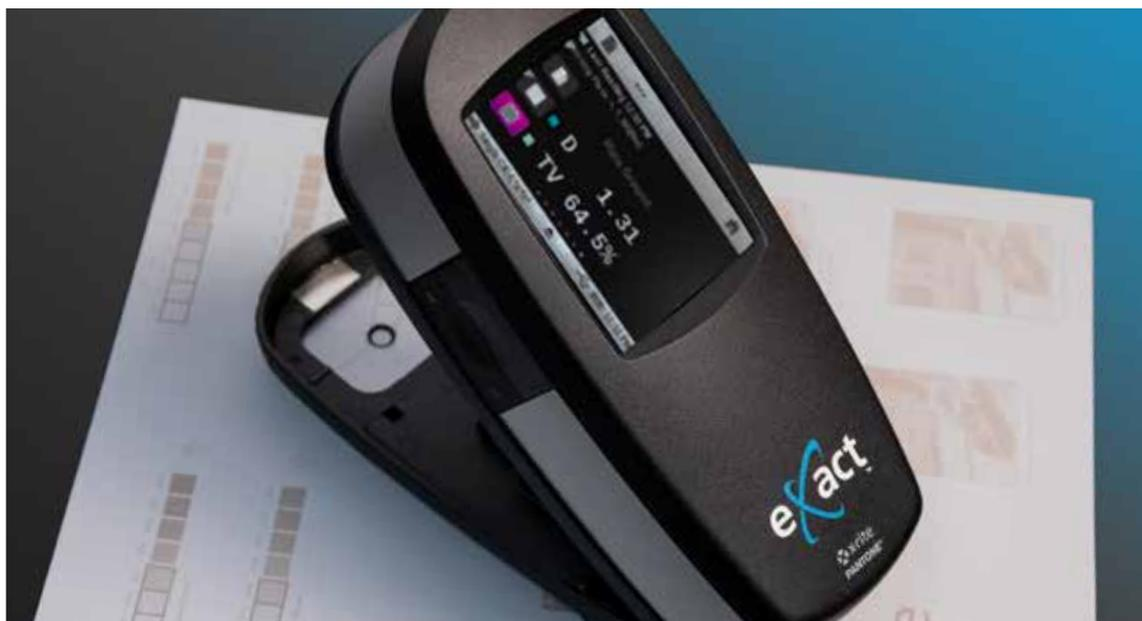
O eXact é um espectrofotômetro versátil para qualquer sala de impressão. Ele pode ser usado para medir chapas positivas e negativas de offset comercial, para aprimorar a precisão e solucionar possíveis problemas de chapa antes que ela seja prensada.
