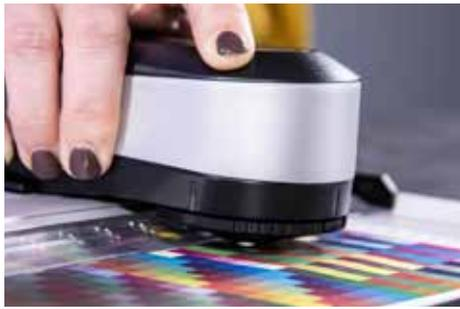
**Doté d'une source lumineuse LED à spectre complet pour des lectures précises**
