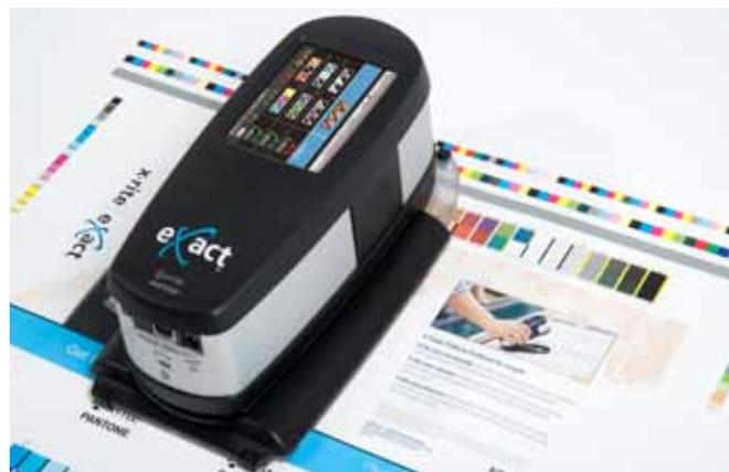
El eje único del eXact Scan garantiza que el instrumento se mueva en línea recta sin necesidad de usar barras guía.
