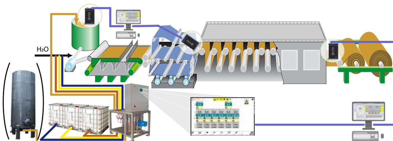
**Sur la ligne de production :** le spectrophotomètre en ligne ColorXRA 45 monté sur un châssis de mesure adapté EFX avec le logiciel ESWin Closed Loop Color Control
