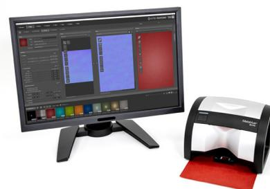
**Semplificazione delle misurazioni spaziali del colore e della trama della superficie, con MetaVue VS3200**
