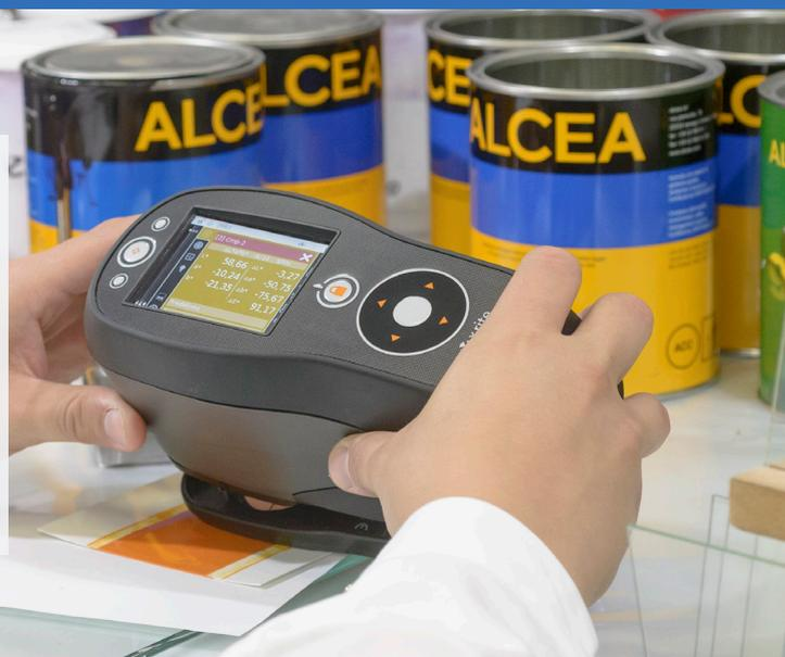
▲ PHOTO : Le Ci60 mesure un échantillon au labo
