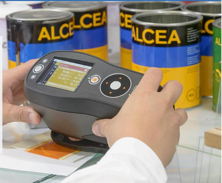
▲ ABBILDUNG: Ci60 bei der Probenmessung im Labor
