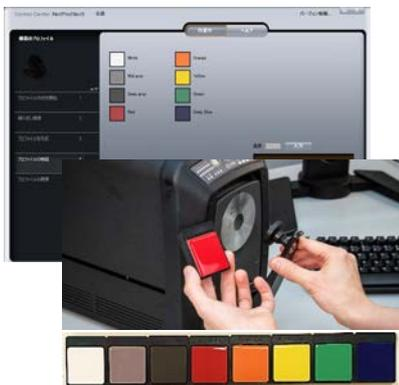
ソフトウェアに表示される操作ガイドに従って、ステップ・バイ・ステップでリファレンスパッチの測定を実施
