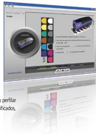
Conserve la precisión y la coherencia de los dispositivos de medición con un sistema que le permite probar, medir y perfilar automáticamente sus instrumentos a través de Internet. Mediante un software sofisticado y estándares físicos certificados, el sistema sólo tarda unos minutos en generar estadísticas sobre el rendimiento de todos los instrumentos en red.
