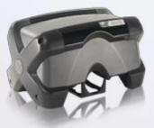
Spectrophotomètre 45°/0° de table sans contact, conçu pour la mesure des couleurs et du brillant sur échantillons secs ou humides. Comporte un capteur de brillance intégré pour les mesures relatives et, lorsqu'il est utilisé avec le logiciel de formulation iMatch, fournit une corrélation humide-sec pour un contrôle-qualité amélioré et des formulations accélérées.
