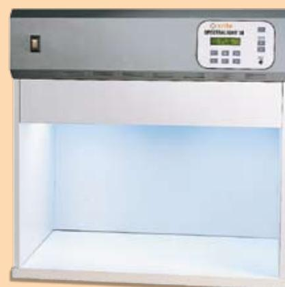
エックスライト社製マクベス標準光源装置のソリューションは、標準光をより正確に再現テクノロジーを通して、マンセル表色系を補完します。このテクノロジーは、フィルターを使用するタングステン・ハロゲン光、日没光、ブレンド光、特許取得済みの7種の蛍光体を含むすべての昼光下における正確なビューイングを可能にするよう洗練されています。また、夜勤者のカラー評価作業にも正確な性能を発揮します。
