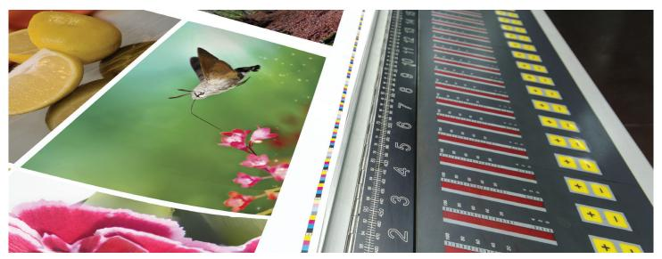
THE SHOP UTILIZES RUTHERFORD GRAPHIC PRODUCTS (RGP) INTELLILOOP™ CLOSED-LOOP, COLOR-CONTROL SYSTEM ON A HEIDELBERG SPEEDMASTER 52 SHEETFED PRESS.
