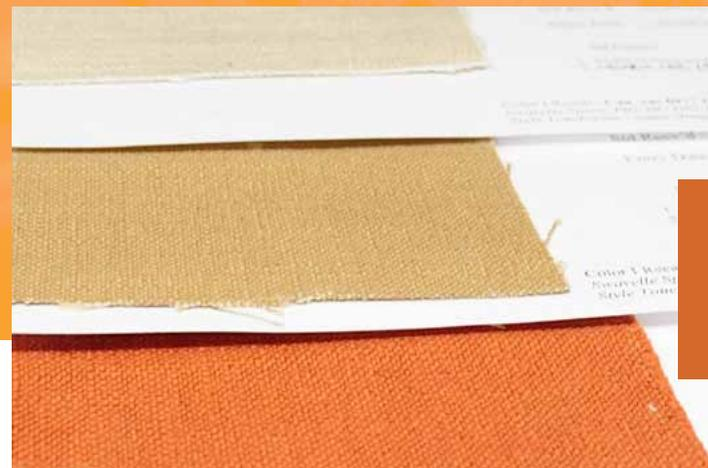
A Ultimate é um tintureiro de gabarito. Guarriello explica: “o tempo, a temperatura e a química são importantes neste processo. Após exaustão da tintura, pegamos uma pequena amostra de tecido, condicionamos, secamos e lemos com o Ci64UV. Com o software iMatch, o resultado é uma trama que diz onde você está no espaço de cor, se está usando o L\*a\*b, CMC ou outros padrões.”
