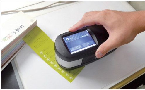
分光光度計『eXact』で見本を読み込むと、登録した原色インキの配合が表示される
