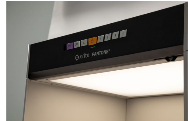
LEDパネル + 2枚の光学拡散板
